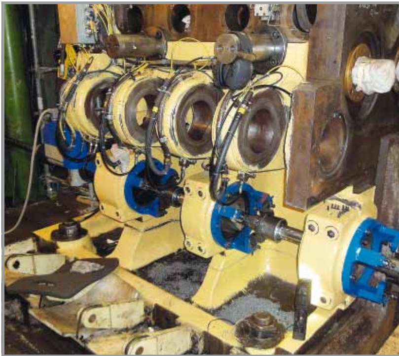
含多个上下支承点的顶出轴区域在相同设置下加工。
