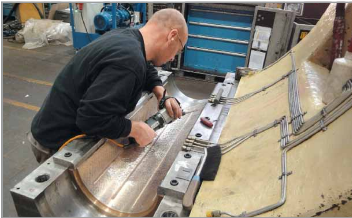
对机床的核心部分（压力机滑块）进行刮研，确保机床零件达到高标准要求。
