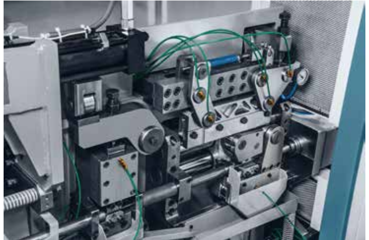
➤ 线性进料: 线性进料确保了切料的最高精度。
