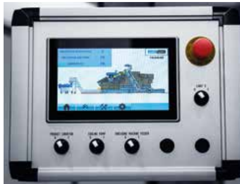
➤ 数字显示屏 卡锣萨尔维 CS 513 TH 采用数字调节,易于保养,旨在最大限度地提高用户使用的便利性。
