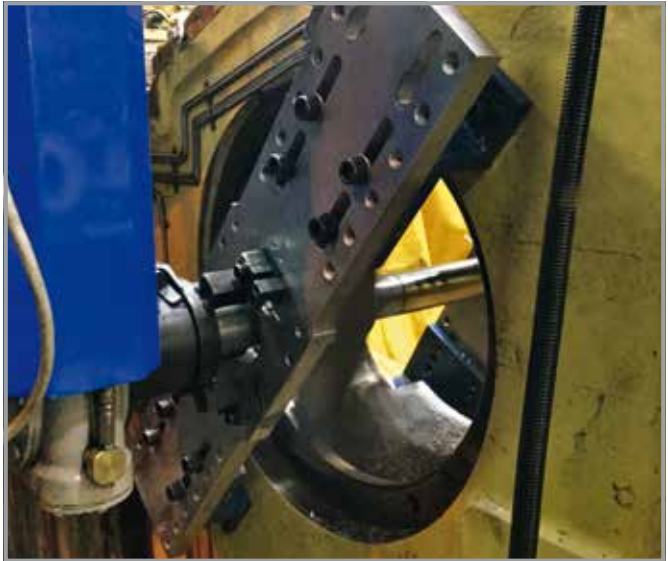
用于加工第 1 成型工位侧曲轴孔的机械设备。
