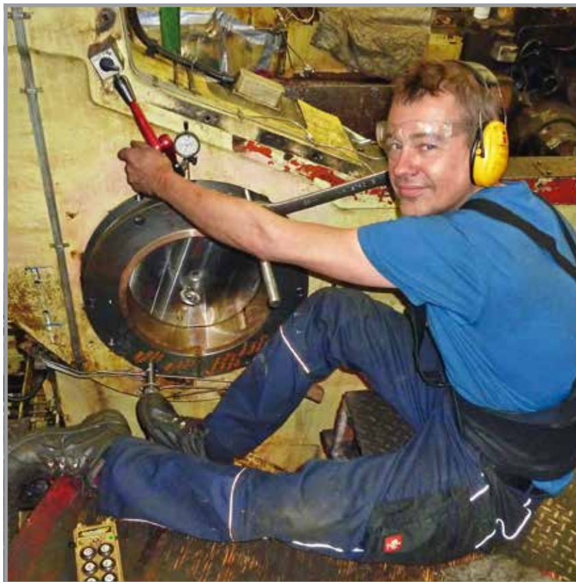
哈特贝尔的维护工程师 Matthias Aebi 正在测量第 4 成型工位上的曲轴孔和曲轴套筒是否匹配。
