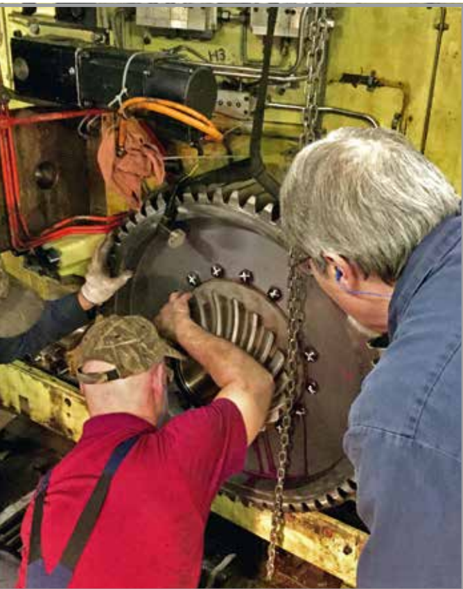
重新装配后，检查新的中间齿轮间隙。
