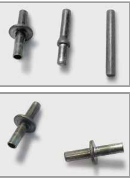
由卡锣萨尔维 CS 001 型号机床制造的零件。第一张图片 (上图) 展示了变形工序。
