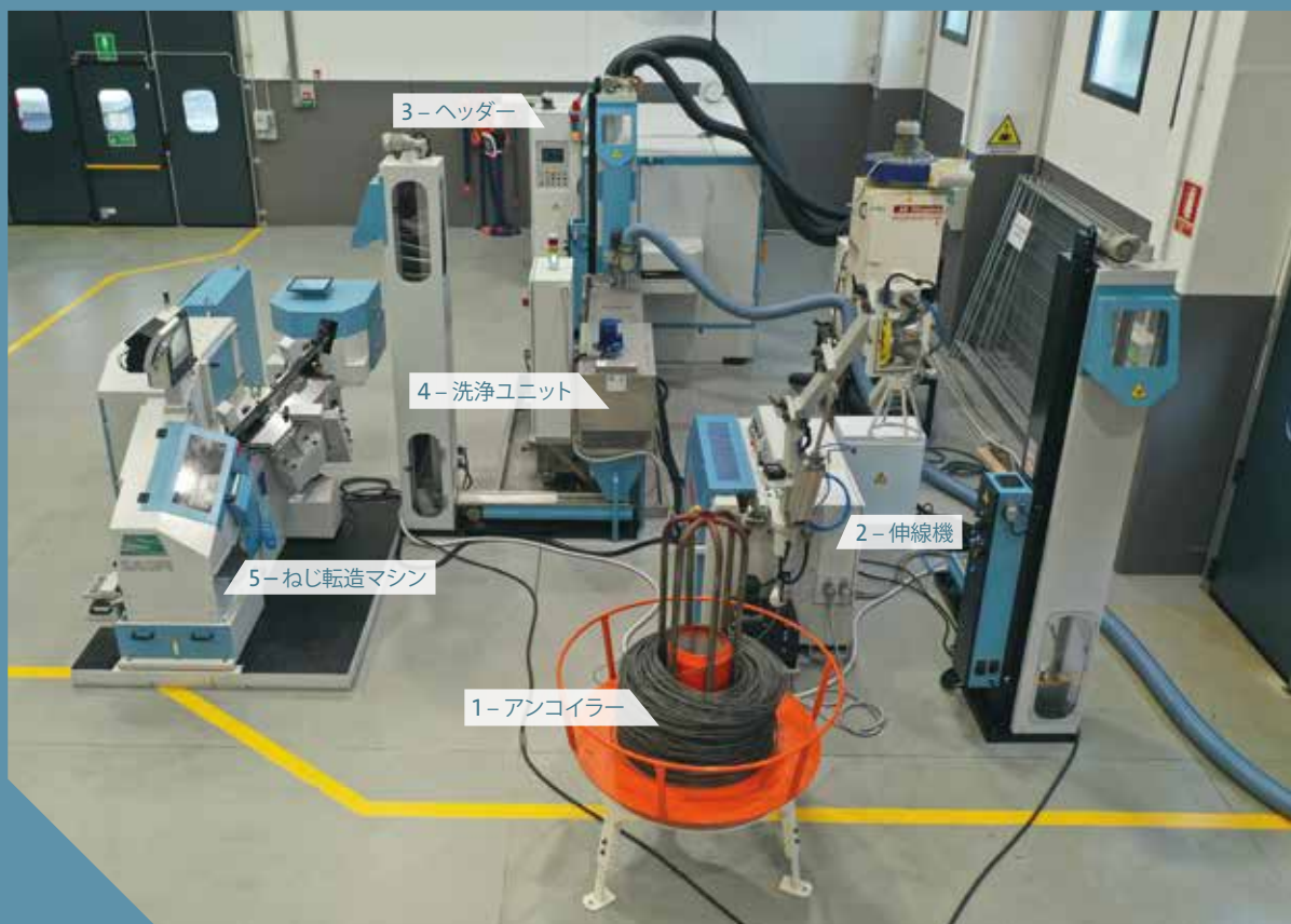
完全な生産ライン:他のマシンと組み合わせた CS 246 E WS
