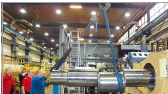
新しいベアリングを 用いたクランク シャフトの再組立
