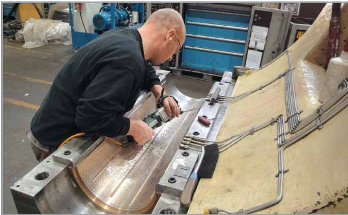
部品に対する厳しい要求を満たすため、マシンの心臓部であるプレスラムにキサゲ加工を実施
