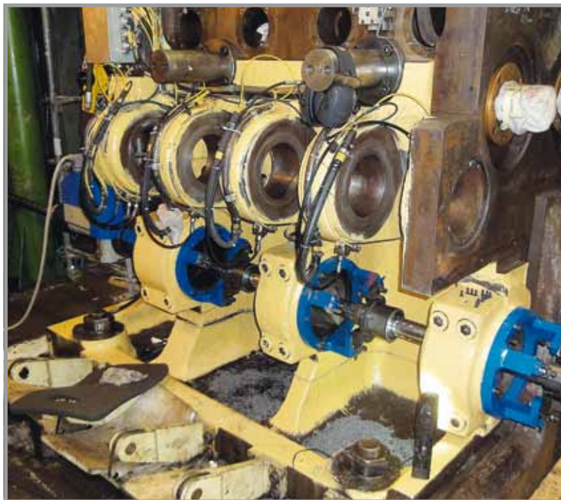
治具を用いて支持部の多いエジェクターシャフト周りを加工
