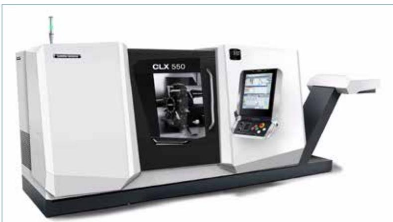
▶ HOTmatic マシン用に、DMG MORI Schweiz AG の新しい旋盤 CLX 550 を使用して、最新技術により直径 480 mm までの実に様々な金型部品を製作することが可能です。
