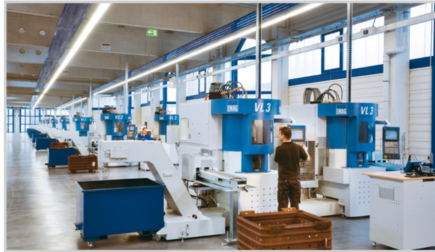
Eine von mehreren Linien für die mechanische Nachbearbeitung von Schmiedeteilen. Die Mitarbeiter führen die Qualitätskontrollen unmittelbar nach der Bearbeitung selbstständig durch.
