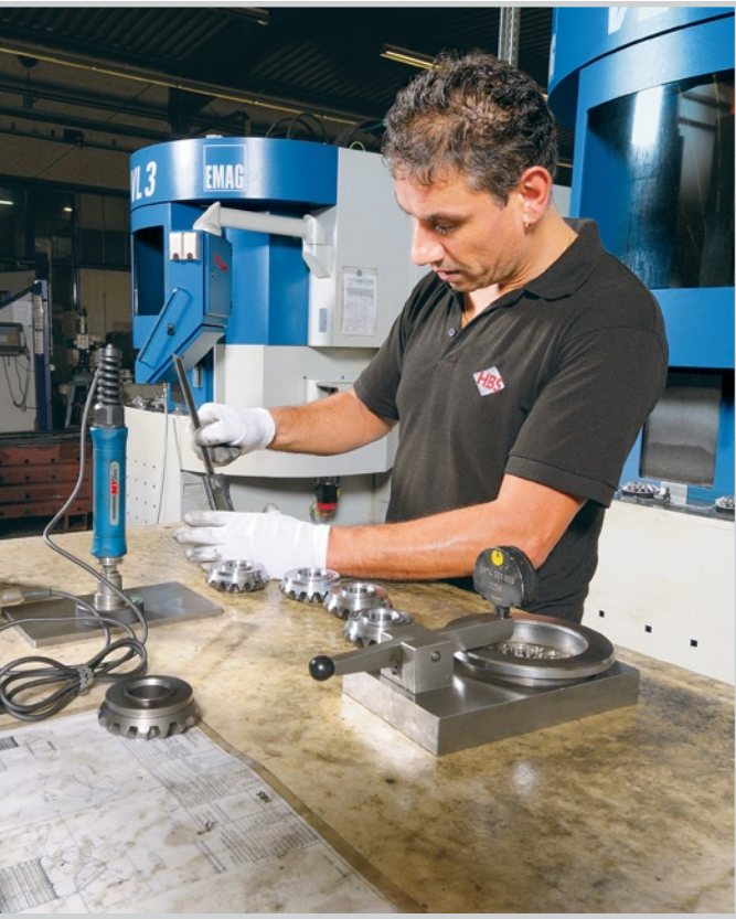
Eine von mehreren Linien für die mechanische Nachbearbeitung von Schmiedeteilen. Die Mitarbeiter führen die Qualitätskontrollen unmittelbar nach der Bearbeitung selbstständig durch.
