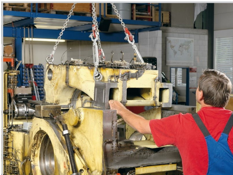
Der Hatebur Servicetechniker demontiert die Maschine vor den Revisionsarbeiten. Hier der Ausbau des Pressschlittens an einer Coldmatic AKP 4-5.
