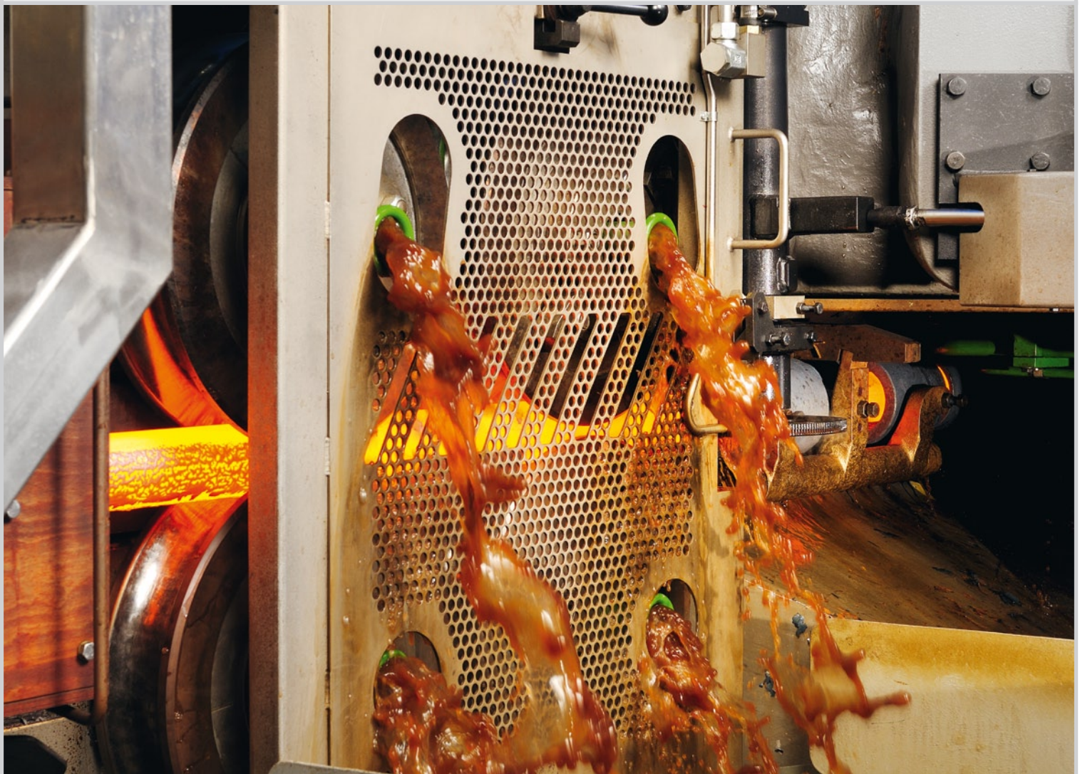
Die Einzugsrollen ziehen das erwärmte Stangenmaterial mit einem gewissen Überhub an den Anschlag der Scherstation.
