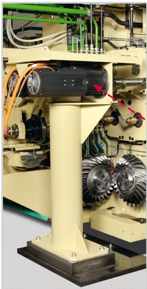
Die Servomotoren sind bei den Grossmaschinen AMP 50, AMP 70 (Bild) und HM 75 freistehend neben der Maschine auf einem Ständer montiert.
