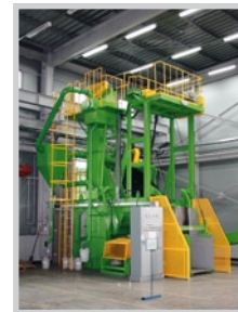
Sandstrahlanlage zur Nachbehandlung der Schmiederohlinge.
