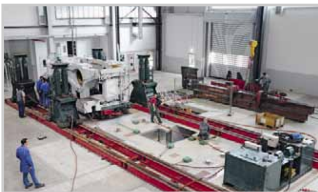
Für die letzten Meter benötigt es hochkonzentriertes Arbeiten, um die Maschine an der korrekten Position abzusetzen. So ist auch die Ausrichtung der Nivellier- und Dämpfungselemente durch den Hatebur Monteur (Fotos in der Reihenfolge ab links oben) von grosser Wichtigkeit.
