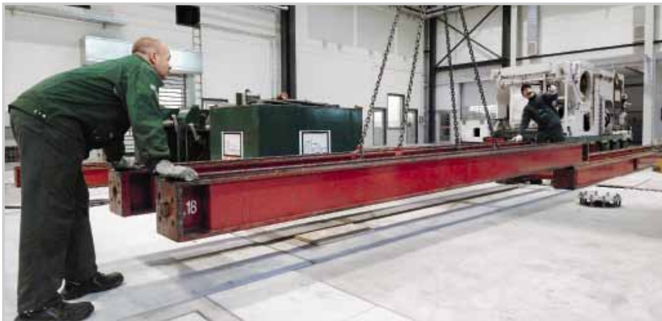
Auf dem exakt ausgerichteten Schienensystem wird die Maschine in ihre Endposition gezogen.
