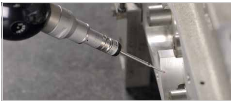
Stichprobenweise werden Teile auf geeichten Messtischen auf Toleranzen geprüft.
