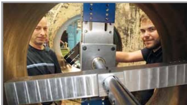
Erstmals Nachbearbeiten der Kurbelwellenbohrung.
