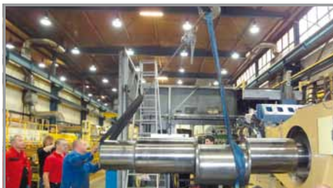
Danach kann die Kurbelwelle mit neuem Lager wieder montiert werden.
