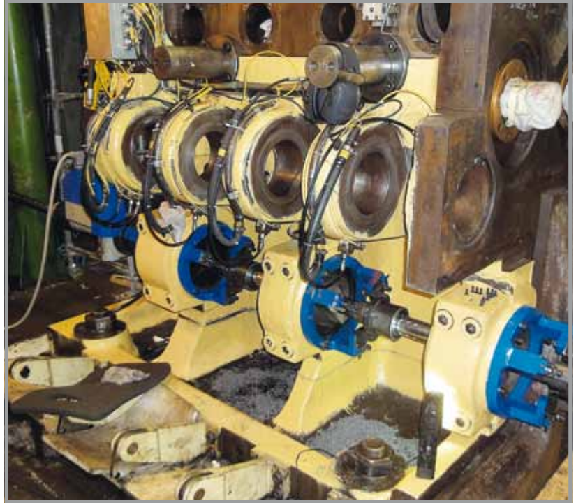
Der Auswerferwellenbereich mit den vielen Lagerstellen unten und oben wird in einem Aufspann bearbeitet.
