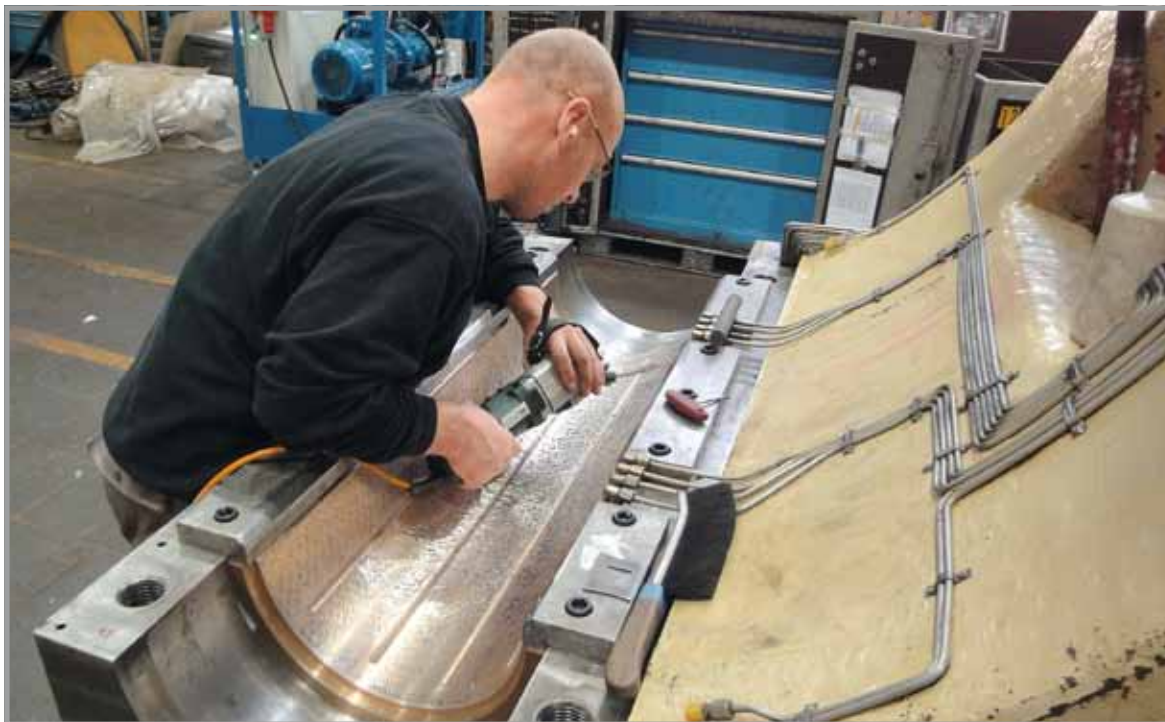
Das Herz der Maschine, der Pressschlitten, wird geschabt, um die hohen Anforderungen an die Maschinenteile zu gewährleisten.
