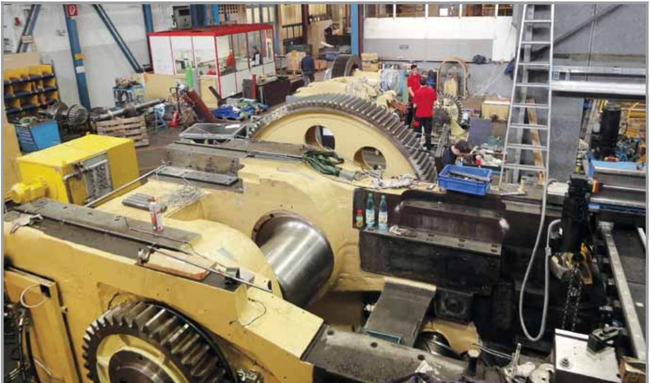
Der Auswerferwellenbereich mit den vielen Lagerstellen unten und oben wird in einem Aufspann bearbeitet.
