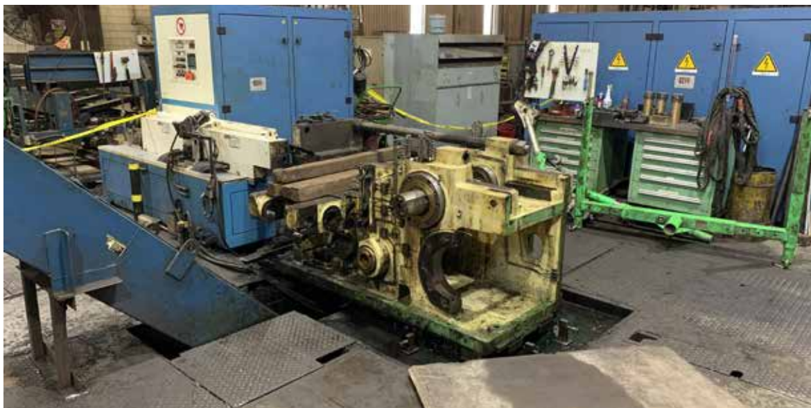
➔ Aus alt mach neu – Schritt 1: Die alte Hatebur AMP 20 zerlegt bis auf den Maschinenkörper und bereit für den Abtransport.
