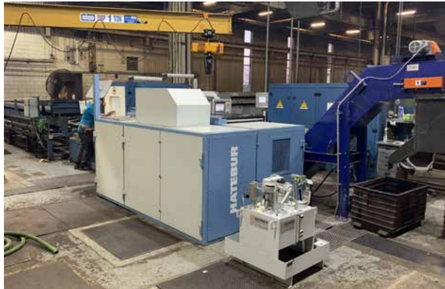
↑ Aus alt mach neu – Schritt 3: Die neue Hatebur HOTmatic AMP 20 N, einschliesslich der Lärmschutzhaube.
