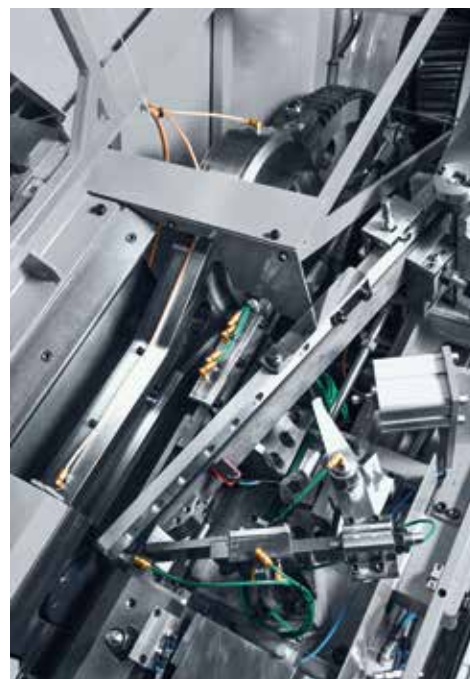
⬅ Staucheinheit Bewährte Qualität von Carlo Salvi: Die 5-Stationen-Presse glänzt mit Flexibilität, Effizienz, Präzision und Bedienungsfreundlichkeit.
