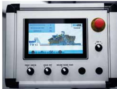
⬅ Digitalanzeige Mit digitaler Einstellung und einfacher Wartung ist die Carlo Salvi CS 513 TH auf maximale Bedienungsfreundlichkeit ausgelegt.
