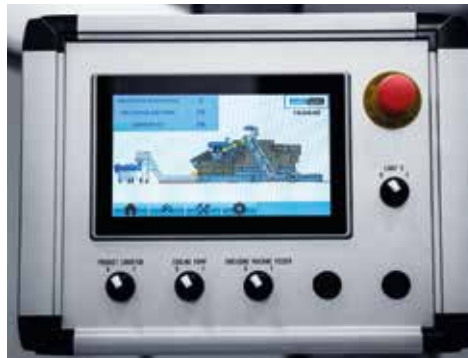
⬅ Display digitale La CS 513 TH, attraverso l'utilizzo di un display digitale, è stata progettata per semplificarne al massimo l'utilizzo e la manutenzione.
