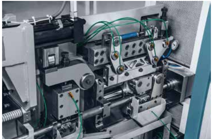
➤ Alimentazione lineare del filo: l'alimentazione lineare del filo assicura la massima precisione dello spezzone grezzo.
