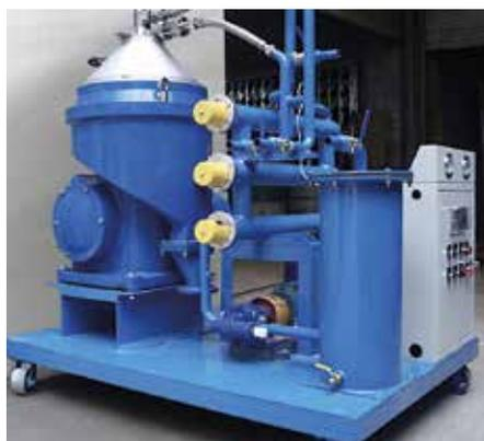
raggiungere i 10.000 giri al minuto. Le impurità possono rappresentare anche il 15% di sostanze solide, il 30% di acqua e lo 0,1% di additivi per formatura. Dopo aver separato le sostanze solide da quelle liquide, i liquidi vengono estratti in modo permanente.
