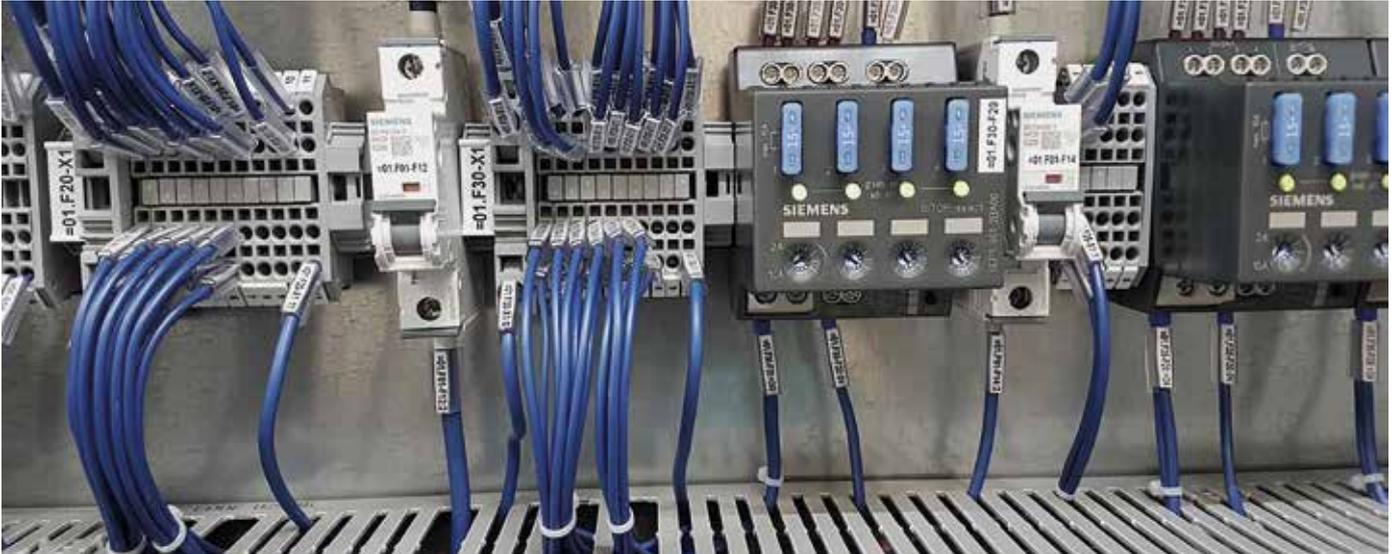
Die Expertinnen und Experten von Carlo Salvi wählen Komponenten und Kabel nach Stücklisten aus Reinach aus, platzieren die elektrischen Komponenten, verdrahten sie und testen den fertigen Schaltschrank im eigenen Prüfzentrum.
