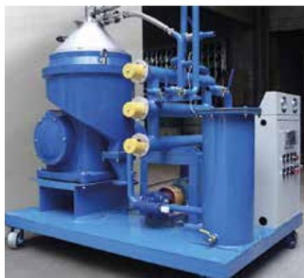
Hierzu saugen Zentripetalpumpen die nach ihrem spezifischen Gewicht getrennten flüssigen Phasen wirkungsvoll ab. Ventile an den Auslässen regulieren den Gegendruck. Durch diese Regulierung erreichen Anwender die korrekte Positionierung der Flüssigkeit-Grenzfläche im Inneren der Trommel und optimieren so die Trennleistung.
