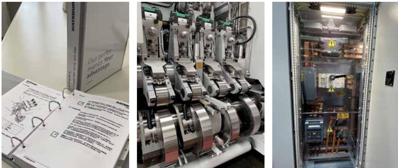
⬆ v.l.n.r.: Maschinendokumentation in chinesischer Sprache, Matrizenauswerfer, Elektroschrank Haupteinspeisung und Maschinenhauptschalter.
