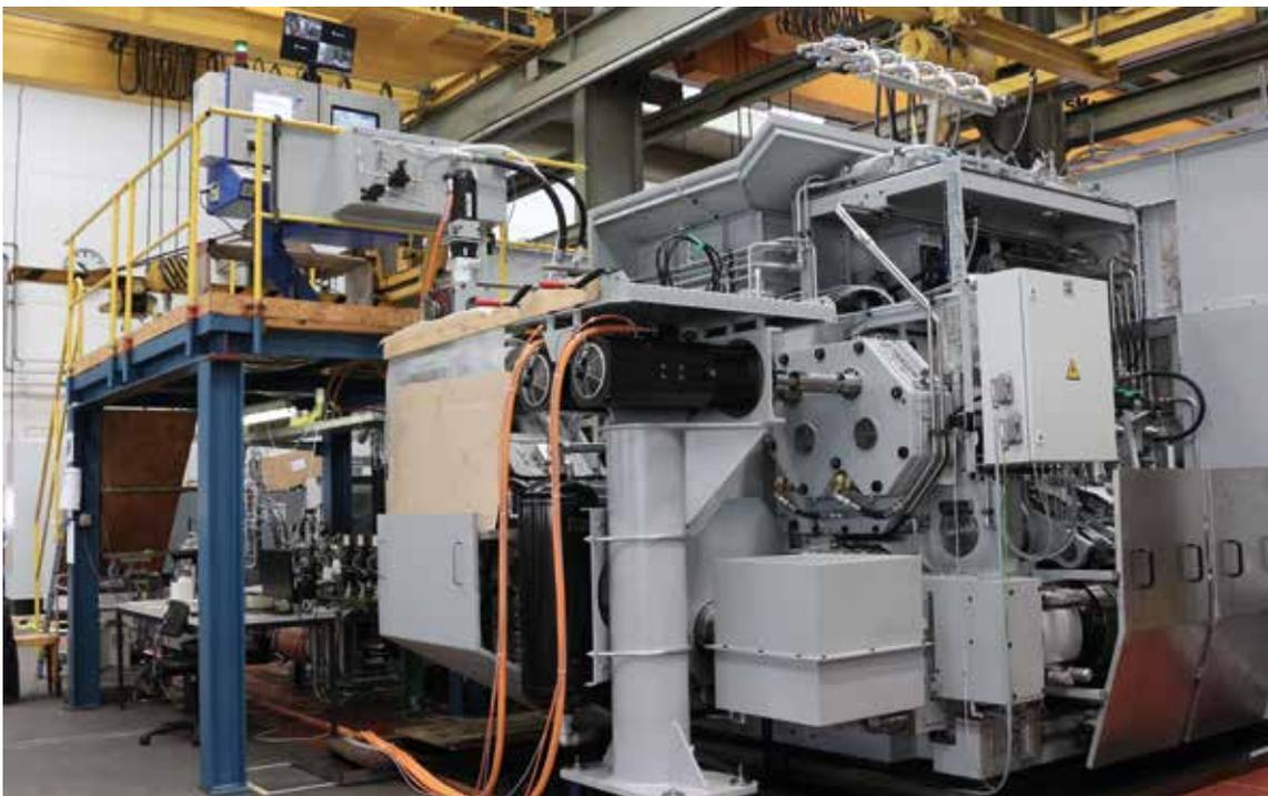
Unsere Werksabnahmen unterscheiden sich weniger nach Gross- und Kleinmaschinen. Jedoch ist bei den Kaltmaschinen eine Vorführproduktion mit einem Musterteil machbar und auch üblich. Da bei unseren Grossmaschinen der Stangenerwärmer und die Werkzeugkühlung erst beim Kunden installiert werden, ist eine Testproduktion nicht möglich. Dafür wird dem Kunden die Maschine im Leerlauf und auf maximaler Produktionsgeschwindigkeit vorgeführt.
