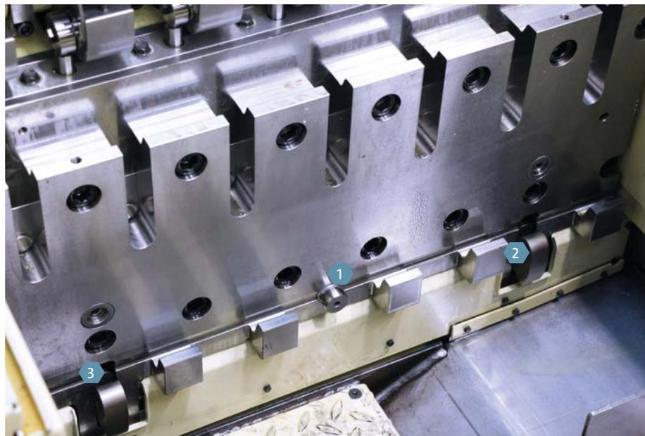
per Knopfdruck hydraulisch gespannt werden. Somit muss nicht jedes Werkzeug einzeln vom Bediener aus der Maschine entnommen werden, was insgesamt die Umrüstzeiten reduziert und den Bedienkomfort für das Personal erhöht.
