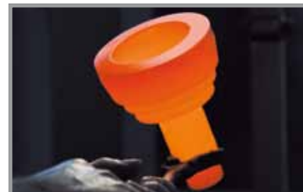
Das noch glühende Pressteil erhält eine erste Sichtkontrolle.
