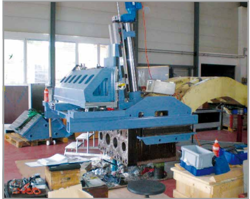
Pressschlittenbearbeitung ausserhalb der Maschine.
