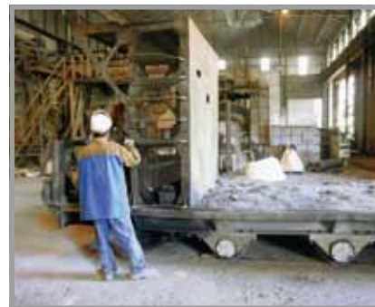
Der Schienentransport der Giesspfannen wird vorbereitet.
