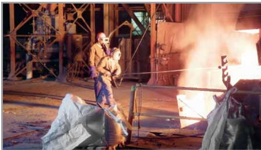
Es wird mehrmals Schlacke abgezogen. Die Materialprobe aus dem Schmelzofen wird sofort in der Spektralanalyse geprüft, bevor das Material in die Giesspfanne geleert wird. Aus der Giesspfanne erfolgt die nächste Materialprobe. Erst wenn diese nach erfolgter Prüfung in Ordnung ist, wird die Schmelze zum Abgießen freigegeben.
