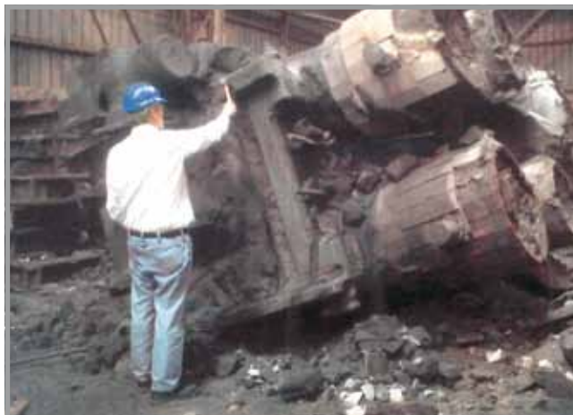
Der ausgegrabene Gussrohling
