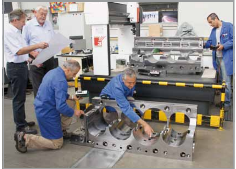
Vlnr.: Beat Hayer (Supervisor Quality Control), Ulrich Hinz (Quality Management), Antonio Mauro, Vincenzo Cristofano, Mehmet Oezbey (alle drei Quality Inspectors): Am Matrizen- und Stempelhalter der HM 75 Hotmatic wird vor der Kanisilbeschichtung eine 100%ige Mass- und Qualitätskontrolle durchgeführt.
