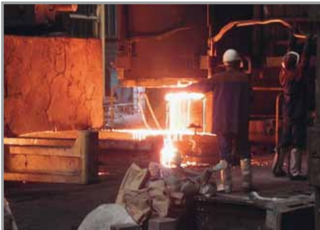
Der Giessvorgang ist beendet.
