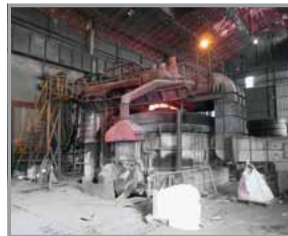
Vorbereiten der Schmelze, z. B. in einem 50-Tonnen-Schmelzofen. Durch die Schlackenöffnung findet die Temperaturmessung statt. Bei 1650 °C ist die Giesstemperatur erreicht.
