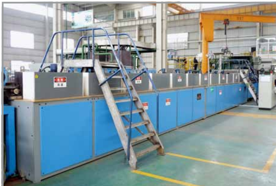
Der Stangenerhitzer der AMP 70.
