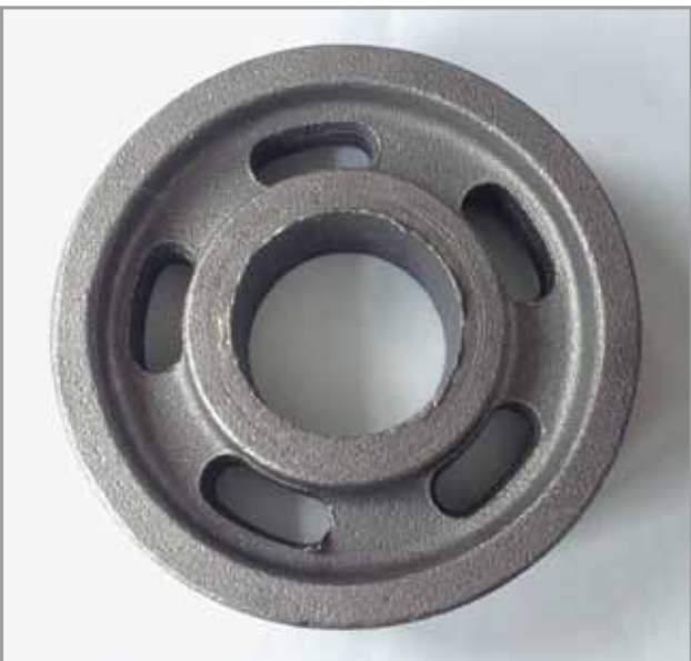
Zahnradrohling für das Audi-Projekt hergestellt mit einem neuen Verfahren.
