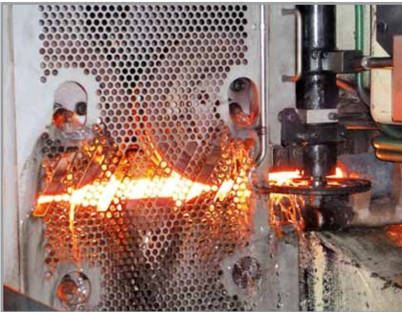
Servoangetriebene Rollen an der Beschickungsstation führen die erhitzte Stange der Maschine zu.
