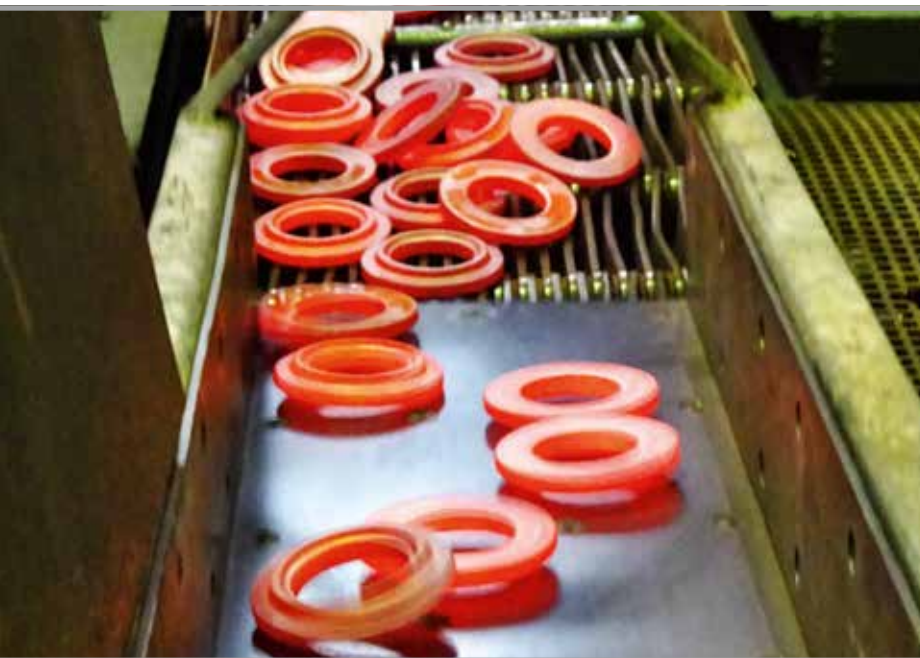
Ein mehrere Meter langes Förderband transportiert die heißen Teile.
