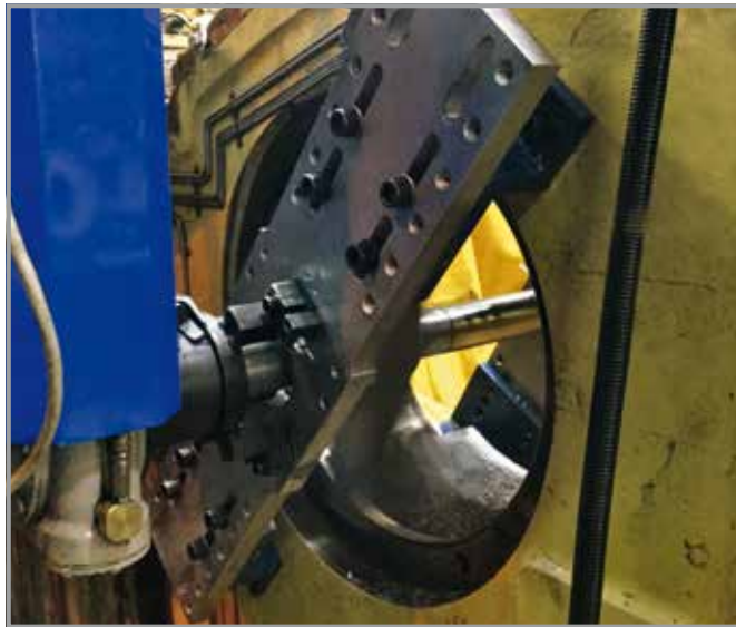
Vorrichtung für die Bearbeitung der Kurbelwellenbohrung der 1. Station.
